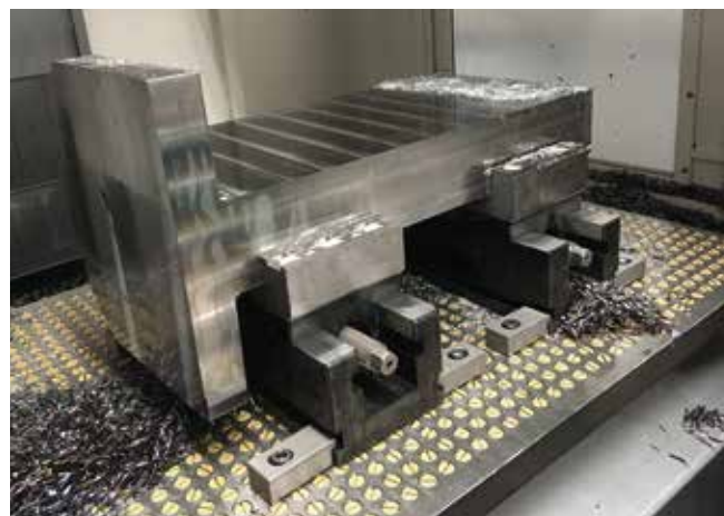
Mechanische Kompaktspanner MSU 360-125 mit Stufen-Wendebacken Mechanical compact vises MSU 360-125 with reversible stepped jaws
