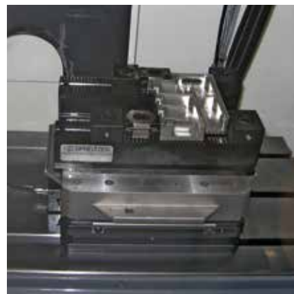
Zwei Mehrfachspannsysteme MMS 260-50-1 auf Palettiersystem Two multiple clamping systems MMS 260-50-1 on a palletizing system
