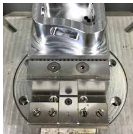
Stufen-Wendebacken mit Gripleiste Reversible stepped jaws with grip insert
