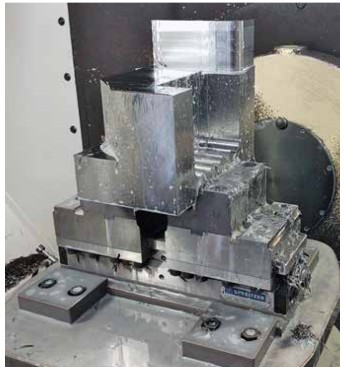
Mechanischer Zentrischspanner MZC 280-100 E, HPC Bearbeitung Mechanical centre-clamping vise MZC 280-100 E, HPC machining
