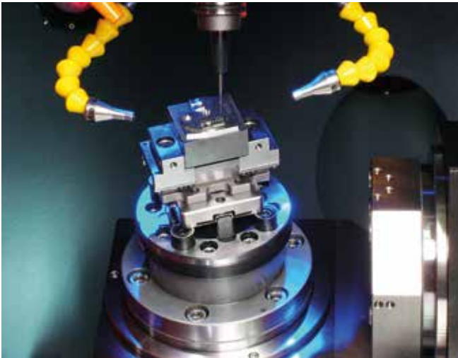
Mechanischer Zentrischspanner MZS 70-36 B auf Palette Mechanical centre-clamping vise MZS 70-36 B on a pallet
