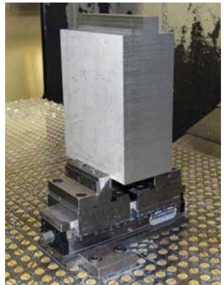
Mechanischer Zentrischspanner MZC 220-80 E, Spannbacken mit HM-Gripeisen Mechanical centre-clamping vise MZC 220-80 E, clamping jaws with carbide grip inserts
