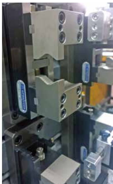
Mechanischer Zentrischspanner MSU 170-60 mit Sonderbacken Mechanical centre-clamping vise MSU 170-60 with custom designed jaws
