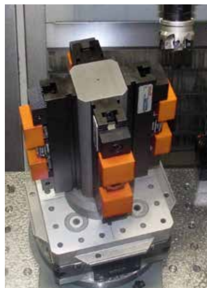
Mehrfachspannsystem MMS 260-50-1 auf Spannturm 90° Multiple clamping system MMS 260-50-1 on a clamping tower 90°
