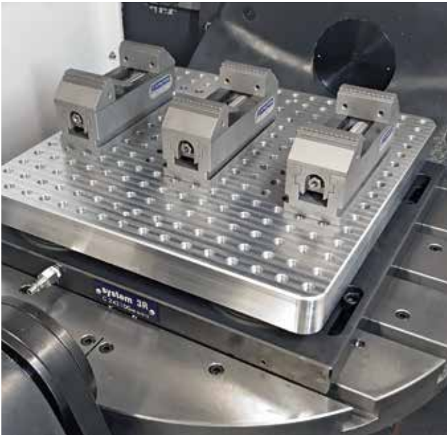
Mechanischer Zentrischspanner MZR 170-60 auf Palette Mechanical centre-clamping vise MZR 170-60 on pallet
