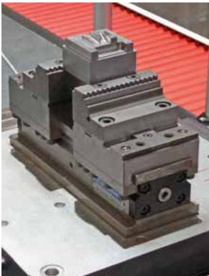
Mechanischer Zentrischspanner MZC 220-80 E, Stufen-Wendebacken mit Gripeisen Mechanical centre-clamping vise MZC 220-80 E, reversible stepped jaws with grip inserts
