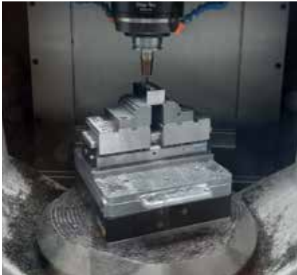
Mechanischer Zentrischspanner MZC 280-100 S auf Palettiersystem Mechanical centre-clamping vise MZC 280-100 S on a palletizing system
