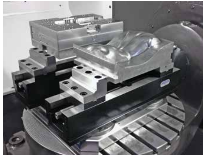
Mechanischer Zentrischspanner MZU 500-125 auf Nullpunktspannsystem Mechanical centre-clamping vise MZU 500-125 on zero-point-system
