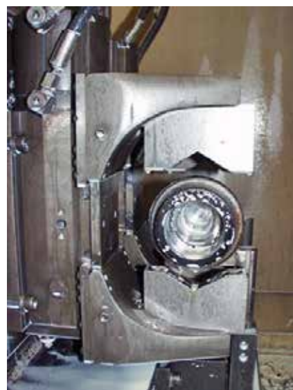
Hydraulischer Zentrischspanner HZS 250-100 D auf horizontal Bearbeitungszentrum
